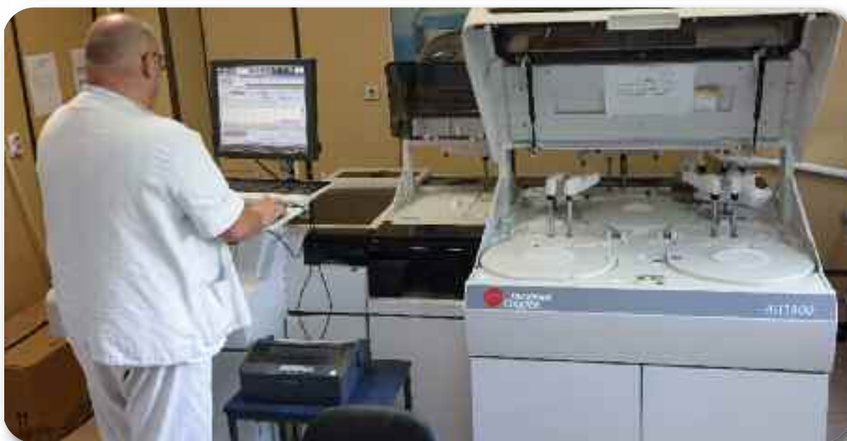
Аутоматски биохемијски анализатор - уређај за брзо и прецизно извођење биохемиских тестова крви и других биолошких узорака
